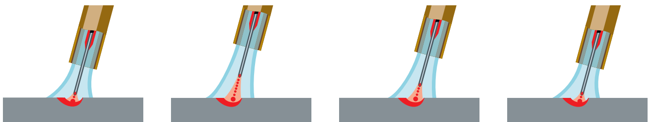
Durch Änderung des Brennerabstandes kann der Schweißer auf veränderte Randbedingungen besser reagieren.
